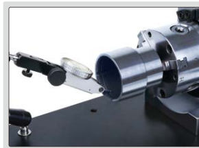
测量点距离卡爪应小于50mm
