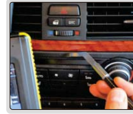
测量汽车仪表台缝隙
