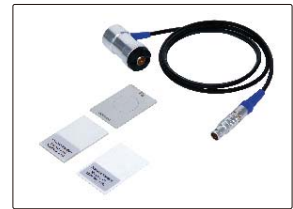
磁感应和涡流二合一测管壁探头(选配), 含对零块和标准片, 用于测量管壁和沟槽 ISO-7000FN-FN90
