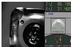
检查切削刃磨损
