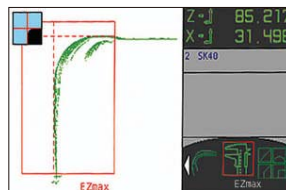
扫描功能, 测量刀具的最大轮廓
