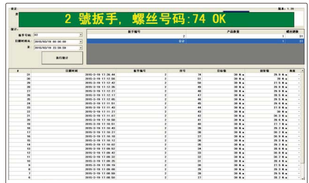
如检测值在公差范围内, 按M键将结果发送到电脑中
